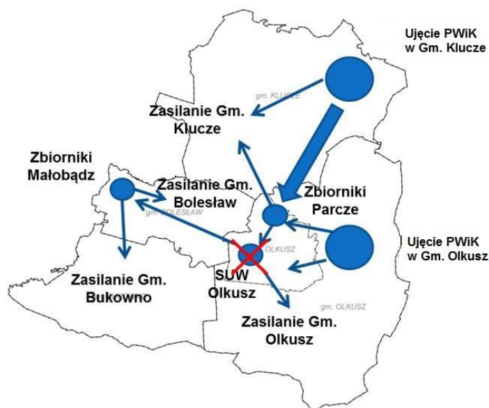
Ryc. 26 Schemat ideowy zasilania w wodę gminy Klucze
